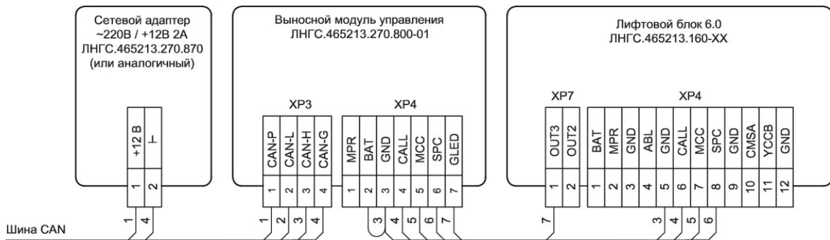
Рисунок Б.2 – Подключение ВМУ к ЛБ6.Х
