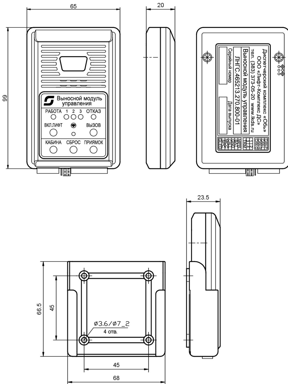
Рисунок А.1 – Габаритные и установочные размеры
