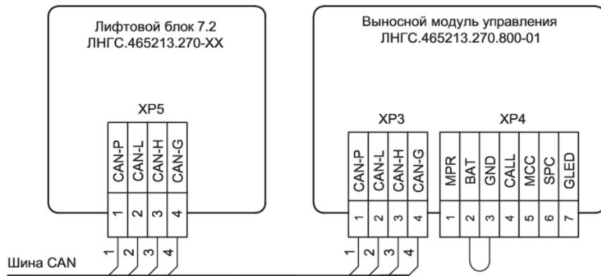
Рисунок Б.1 – Подключение ВМУ к ЛБ7.2
