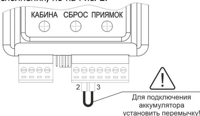
Рисунок 2 – Подключение аккумуляторной батареи ВМУ
